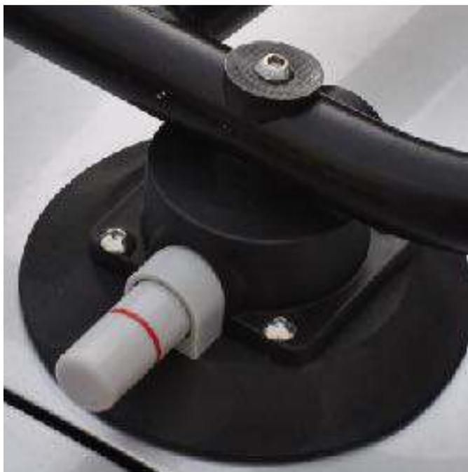
3. Appuyez vers le bas sur la grille au-dessus de chaque tasse et pompe l'air hors des ventouses à l'aide du plongeur la ligne rouge disparaîtra lorsque la tasse est entièrement comprimé. Vous devrez peut-être appuyer fermement pour fixer la tasse.
